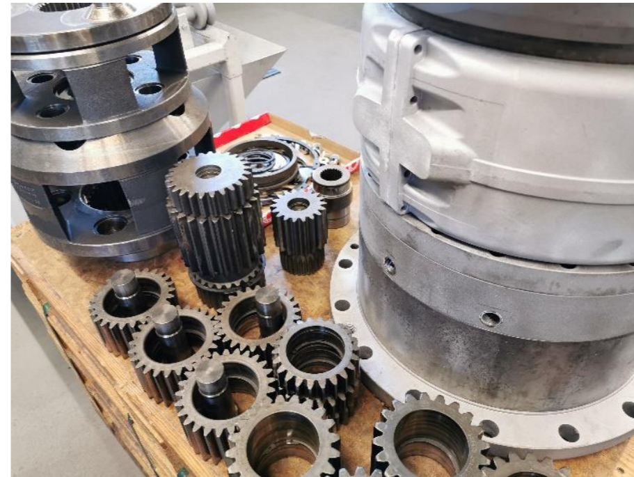
Vorbereitung und Rüsten der Bauteile für die Montage
